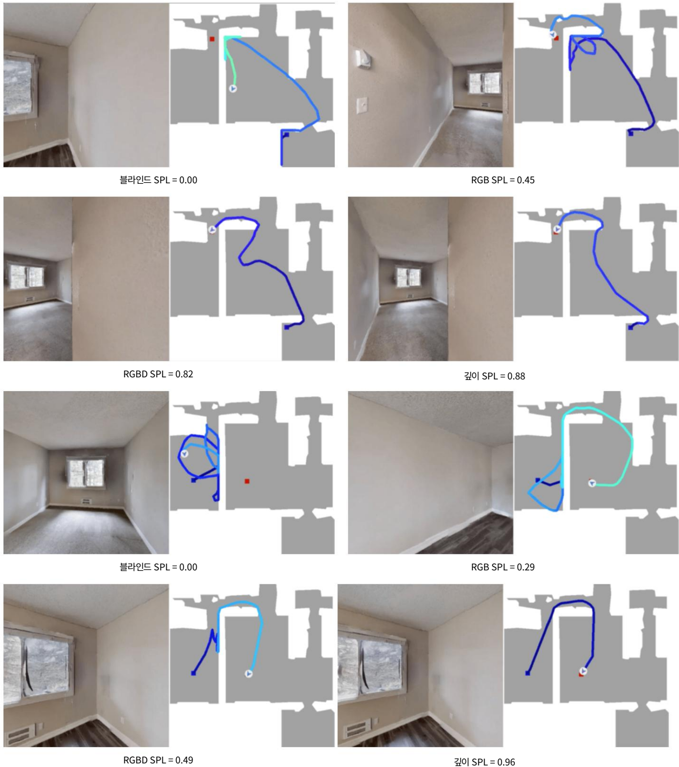
그림 12: RL(PPO) 에이전트의 다양한 감각 구성에 대한 추가 탐색 예제 에피소드, Gibson 및 MP3D val 세트의 시도를 시각화합니다. 파란색 점과 빨간색 점은 시작 및 목표 위치를 나타내고 파란색 화살표는 최종 에이전트 위치를 나타냅니다. 청록색 선은 에이전트의 궤적입니다. 허용되는 상단원 단계의 최대 수에 도달하면 색상이 파란색에서 빨간색으로 바뀝니다.
