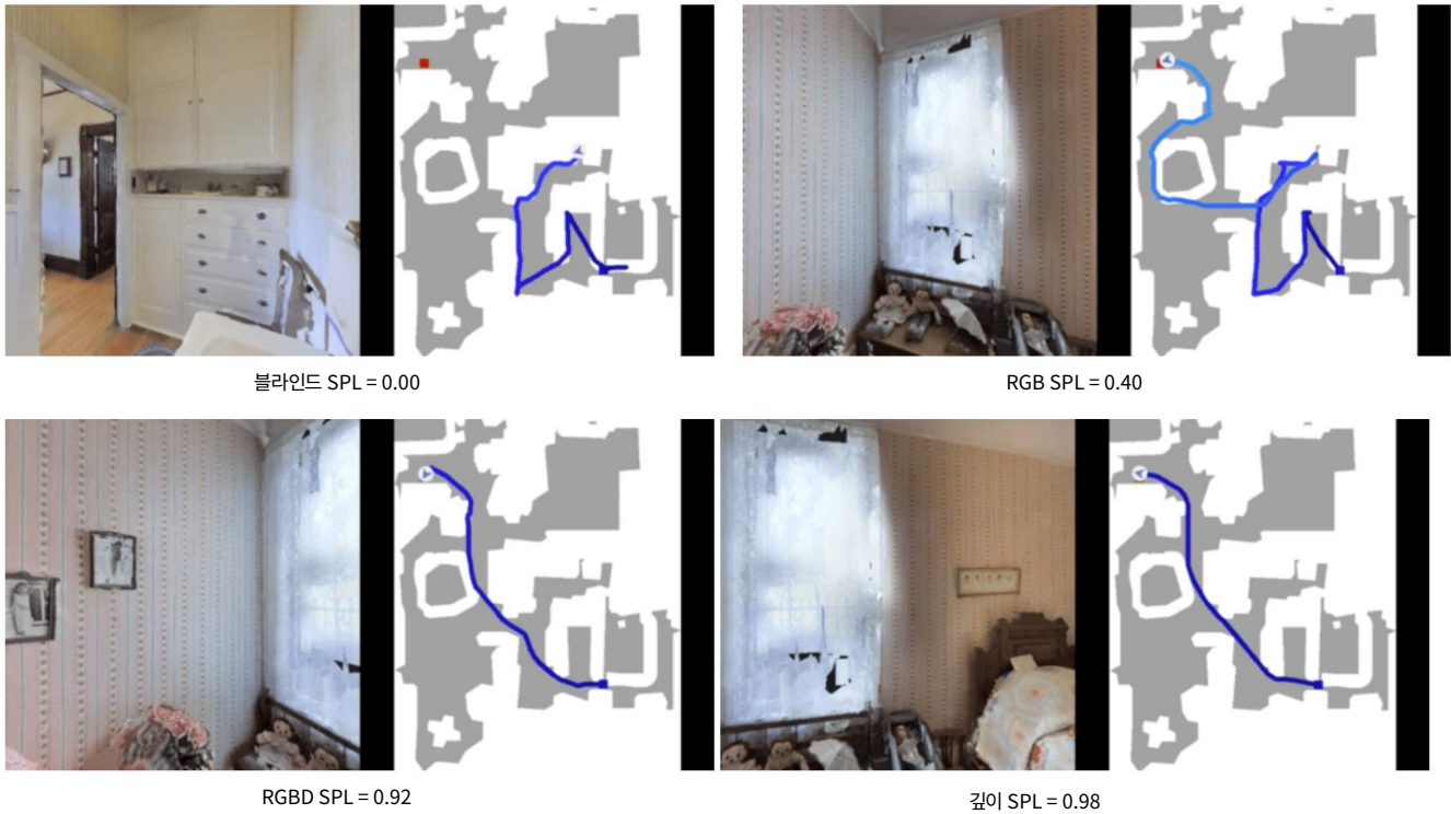
그림 12: RL(PPO) 에이전트의 다양한 감각 구성에 대한 추가 탐색 억제 에피소드, Gibson 및 MP3D val 세트의 시도를 시각화합니다. 파란색 점과 빨간색 점은 시작 및 목표 위치를 나타내고 파란색 화살표는 최종 에이전트 위치를 나타냅니다. 청록색 선은 에이전트의 궤적입니다. 허용되는 상단원 단계의 최대 수에 도달하면 색상이 파란색에서 빨간색으로 바뀝니다.
